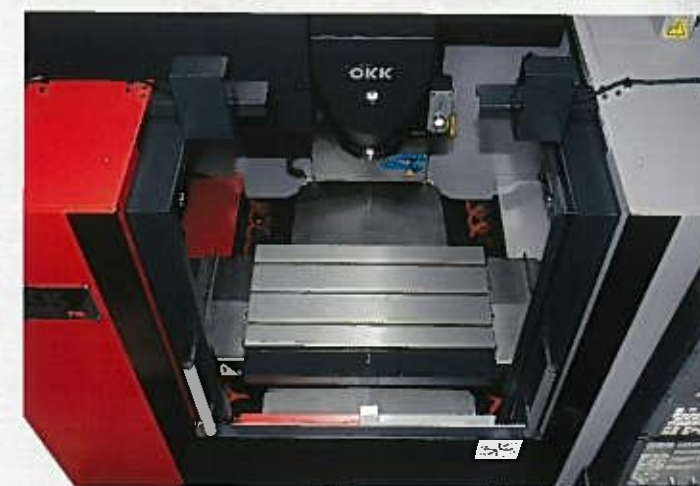
機械天井部まで扉が開くことで、クレーン作業でのワークの積み降ろしがスムーズに行えます。
